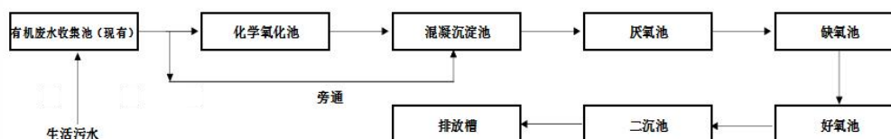
图 2-9 有机废水处理工艺流程图
