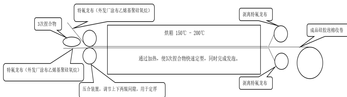
5.2-2 压合机结构示意图
