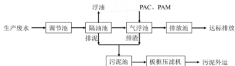
图 4-4 废水处理工艺流程图
