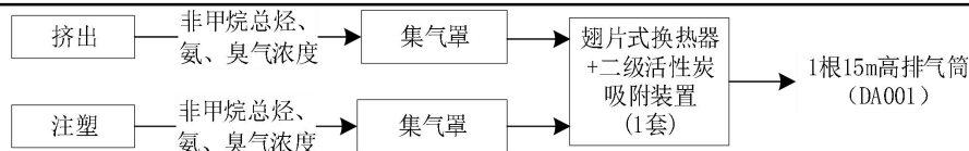
图 4-1 本项目废气收集、治理流向图
