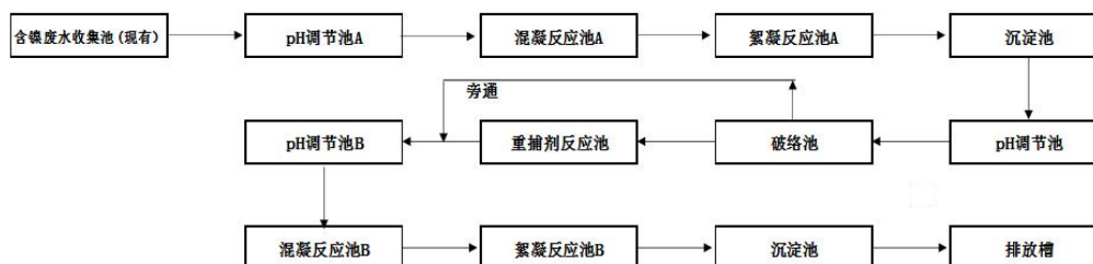
图 2-6 含镍废水处理工艺流程图
