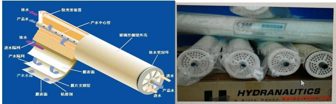
图 5-5 纯水制备原理
