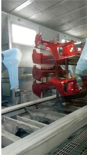
双侧侧挂保险杠机器人喷涂线
