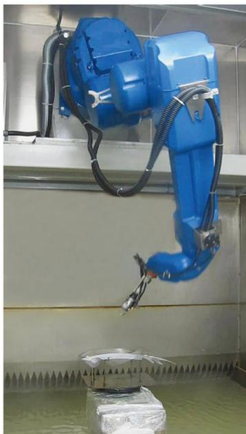
汽车车灯壁挂式机器人自动喷涂系统
