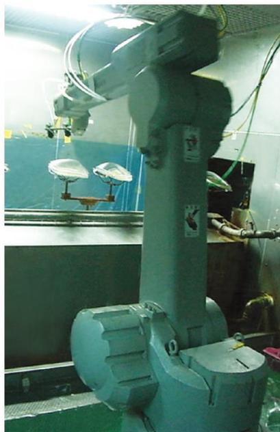
汽车车灯落地式机器人自动喷涂系统
