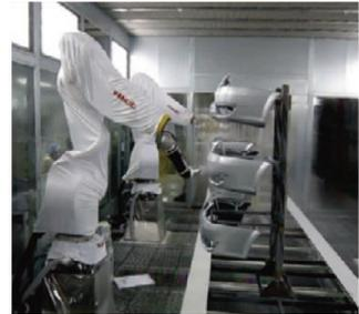
滑撬输送单侧挂保险杠机器人喷涂线
