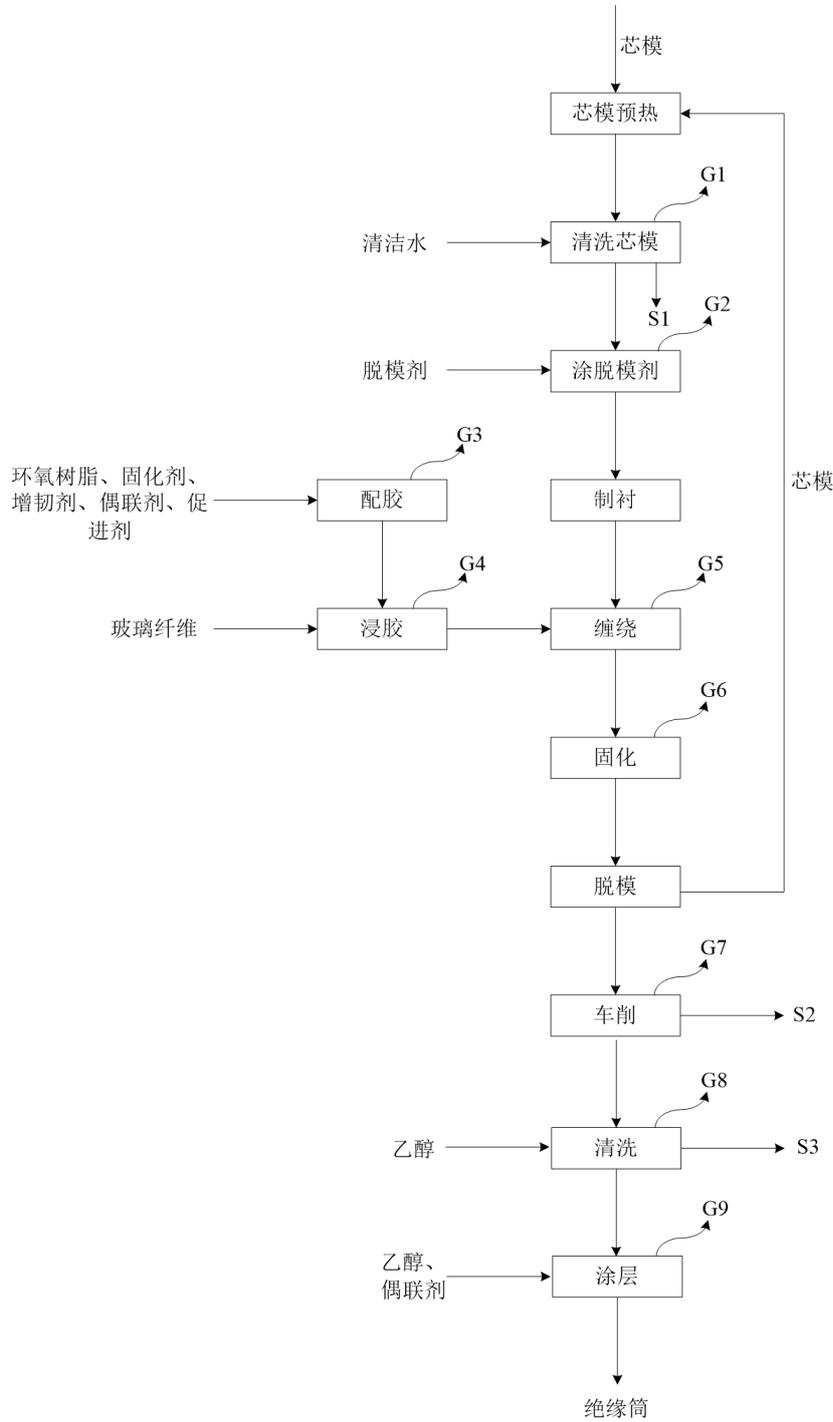
图 6 空心复合绝缘子复合生产工艺流程图
