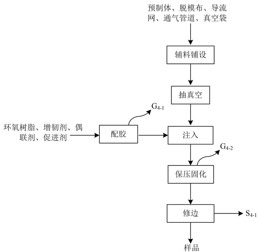
图 4 真空浇注研发工艺流程图
