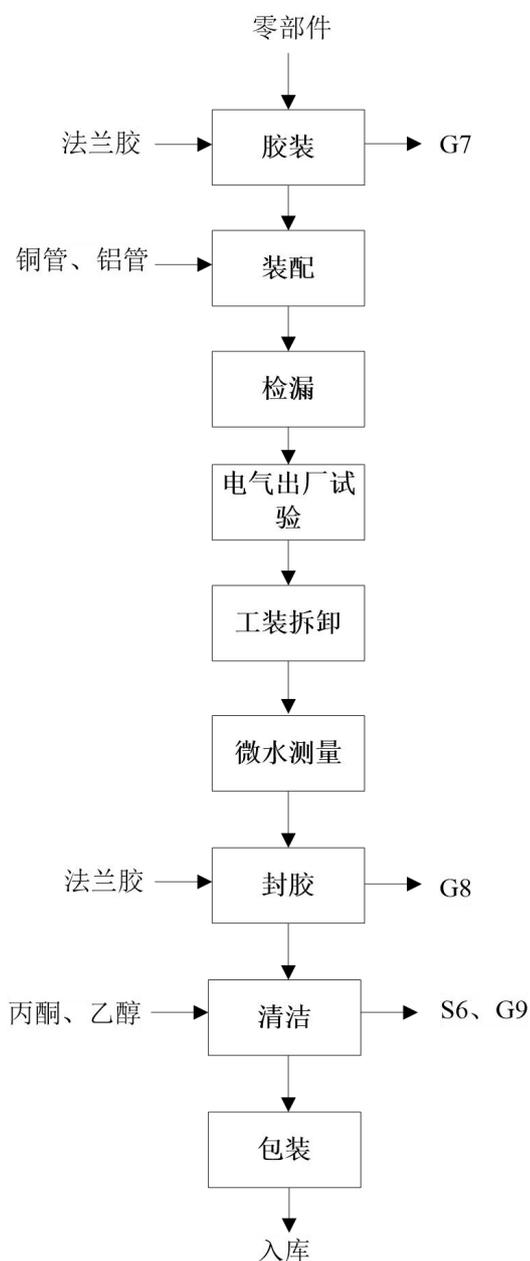
图 5-2 气体绝缘复合套管生产工艺流程图
