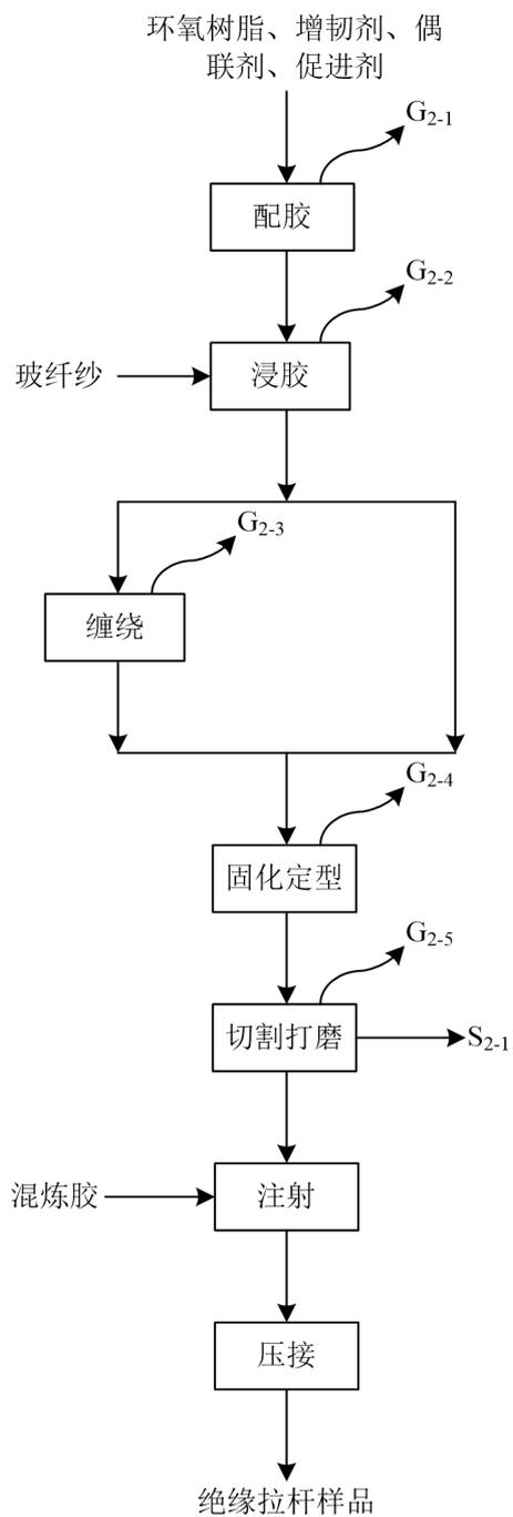
图 2 绝缘拉杆研发工艺 2 流程图
