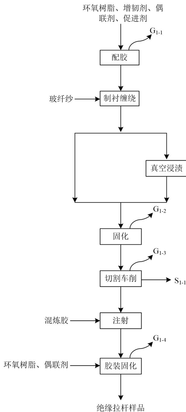
图 1 绝缘拉杆研发工艺 1 流程图
