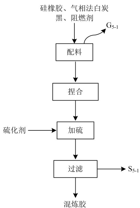
图 5 混炼胶研发工艺流程图
