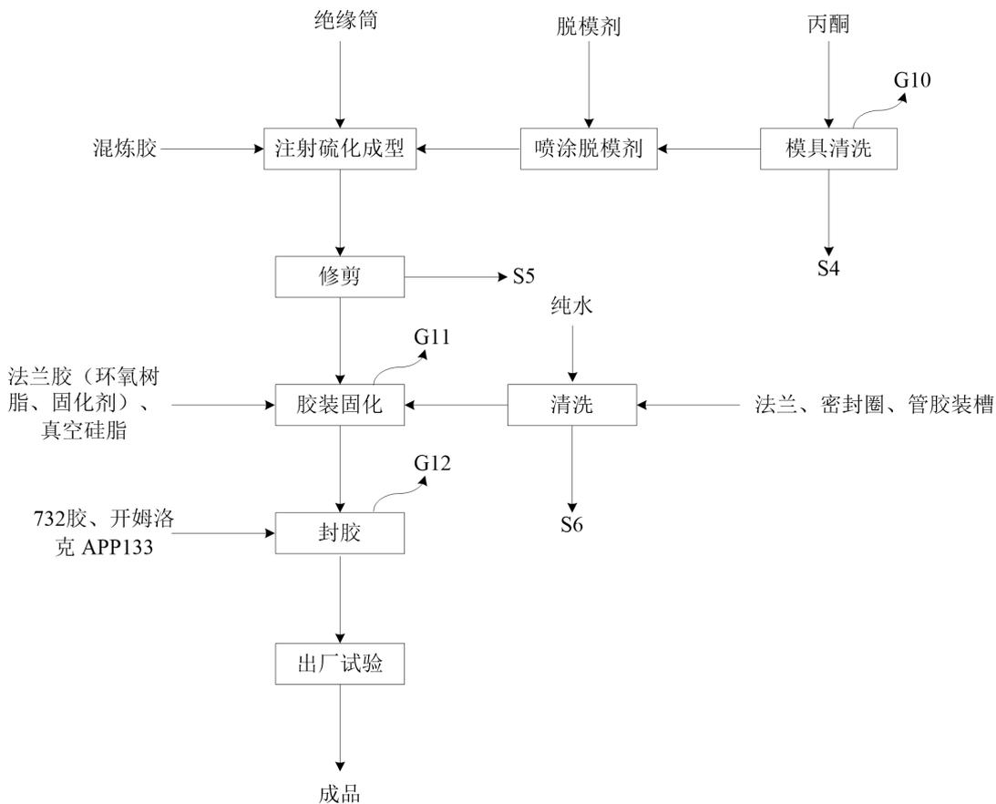
图 7 空心复合绝缘子成型生产工艺流程图
