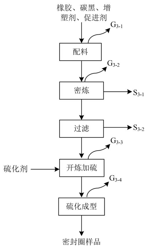
图3 密封圈研发工艺流程图
