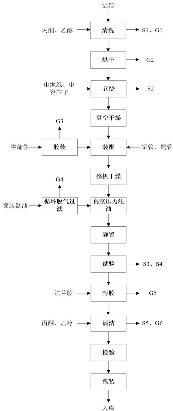
图 5-1 变压器复合套管工艺流程及产污节点图
