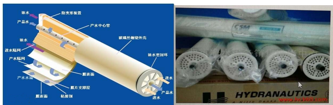
图 3.4-1 纯水制备原理
